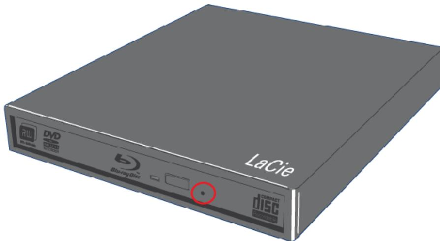
3. Introduzca por el orificio de expulsión de emergencia un objeto metálico fino y alargado, por ejemplo el extremo de un clip, hasta presionar el mecanismo de expulsión manual. Sentirá que el mecanismo expulsa la bandeja de discos.
