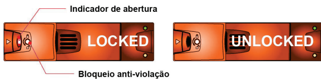
Figura 2: Bloqueio anti-violação de unidades
